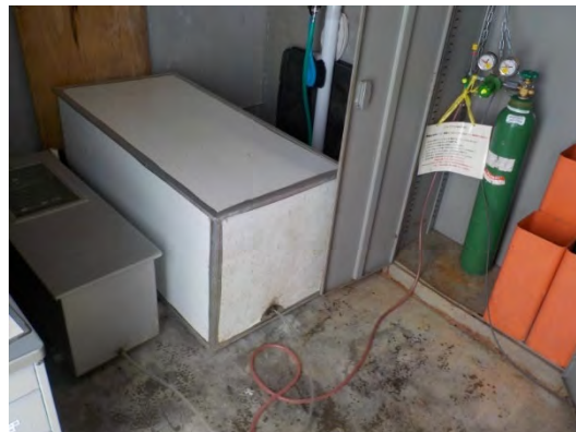
CO 2 ガスを注入する処分ボックス（写真左の2つ）
