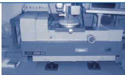
室温20°Cの計量計測室(内径測定機)。
