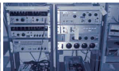
基準電圧電流発生器(指示電気計器を校正するための標準器)。
