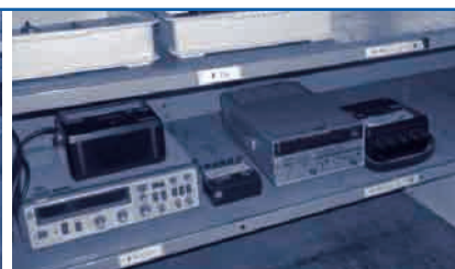
デジタルマルチメータ(デジタル表示の電流・電圧・抵抗などのマルチ計測器)。
