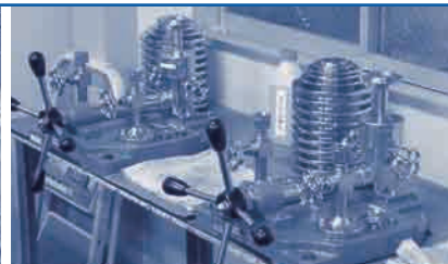
圧力計を校正する機器。
