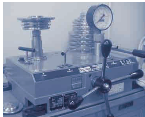
圧力計の校正状況。
