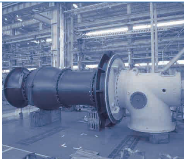
立型雨水排水ポンプ。
