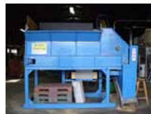
<第一粉砕機定量供給機>
