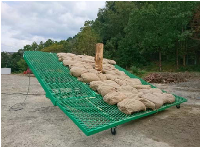
導入した傾斜伐倒装置
