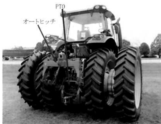
図9 トラクタのオートヒッチとPTO
