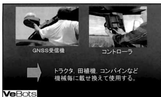
図4 Multi-GNSS 航法センサとロボットコントローラの使い方
