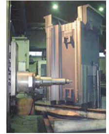
横中グリ盤にて 工作機械部品を加工
