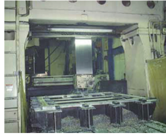
五面加工機にて SUSフランジを加工
