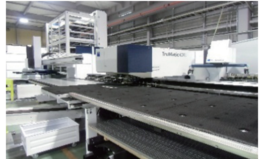
ディスクレーザー・パンチ複合機
