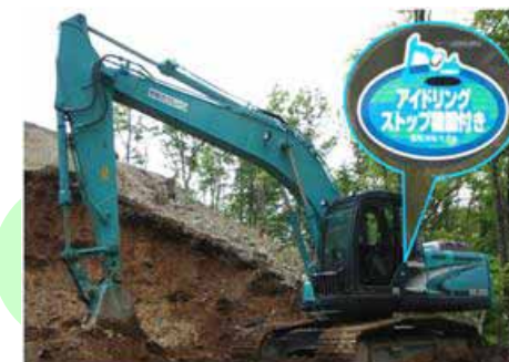
アイドリングストップ機能を搭載した重機
