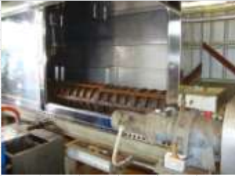
③「スクリュープレス」 原料を煮出し、骨などの固形物を除く。
