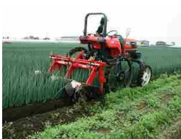
写真 -9-5 管理用ビークルによる培土作業
