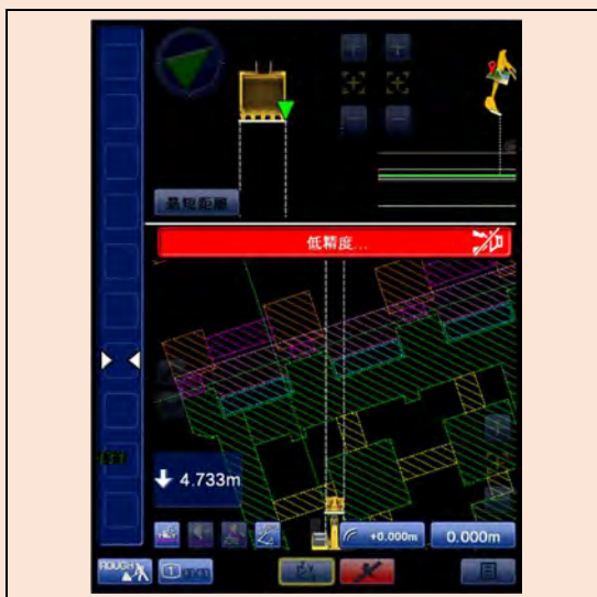
写真 建機モニターでの警告の表示
