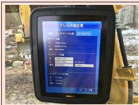
写真 建機モニターでのバケット刃先の位置情報の表示
