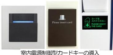
室内電源制御型カードキーの導入
