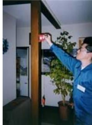
写真2-9 下げ振りによる傾斜の測定
