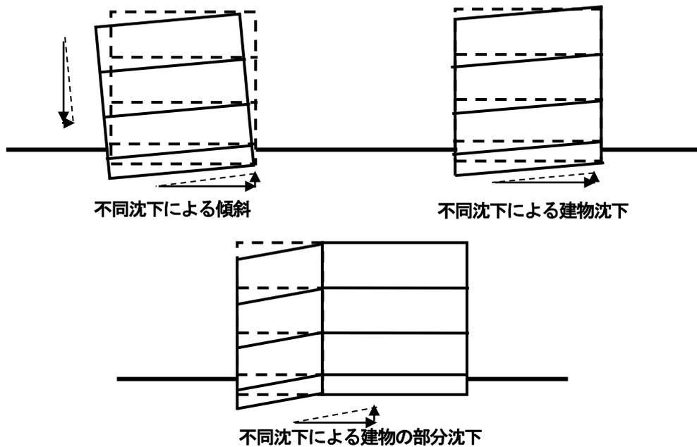
図3-1 鉄骨造建築物の沈下と傾斜原因
