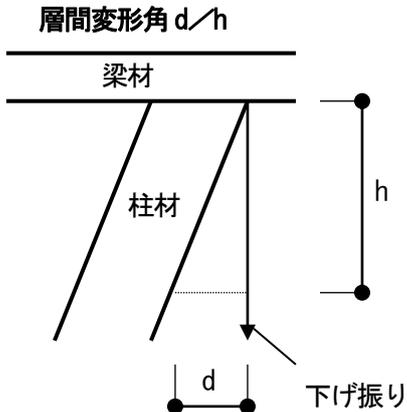
図3-3 傾斜の測定
