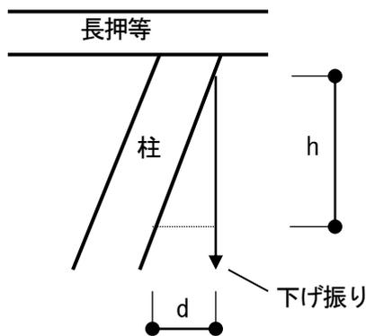
図2-1 傾斜の測定
