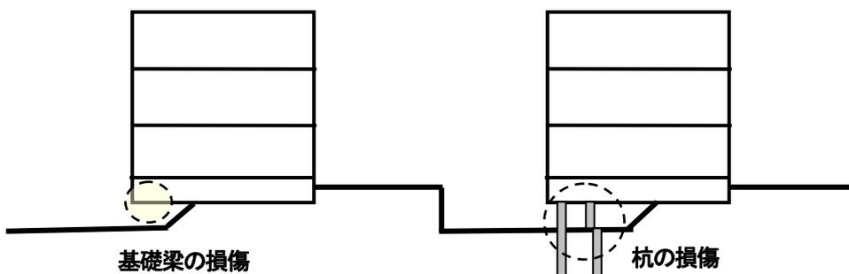
図3-2 地盤沈下などによる基礎部の損傷
