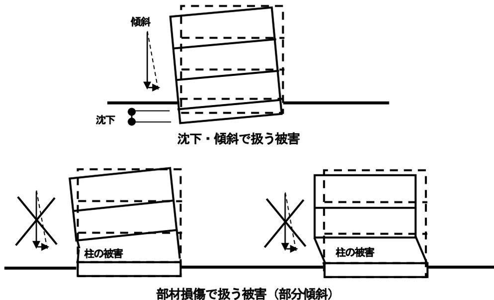
図 4-2 RC・SRC造建築物の傾斜被害
