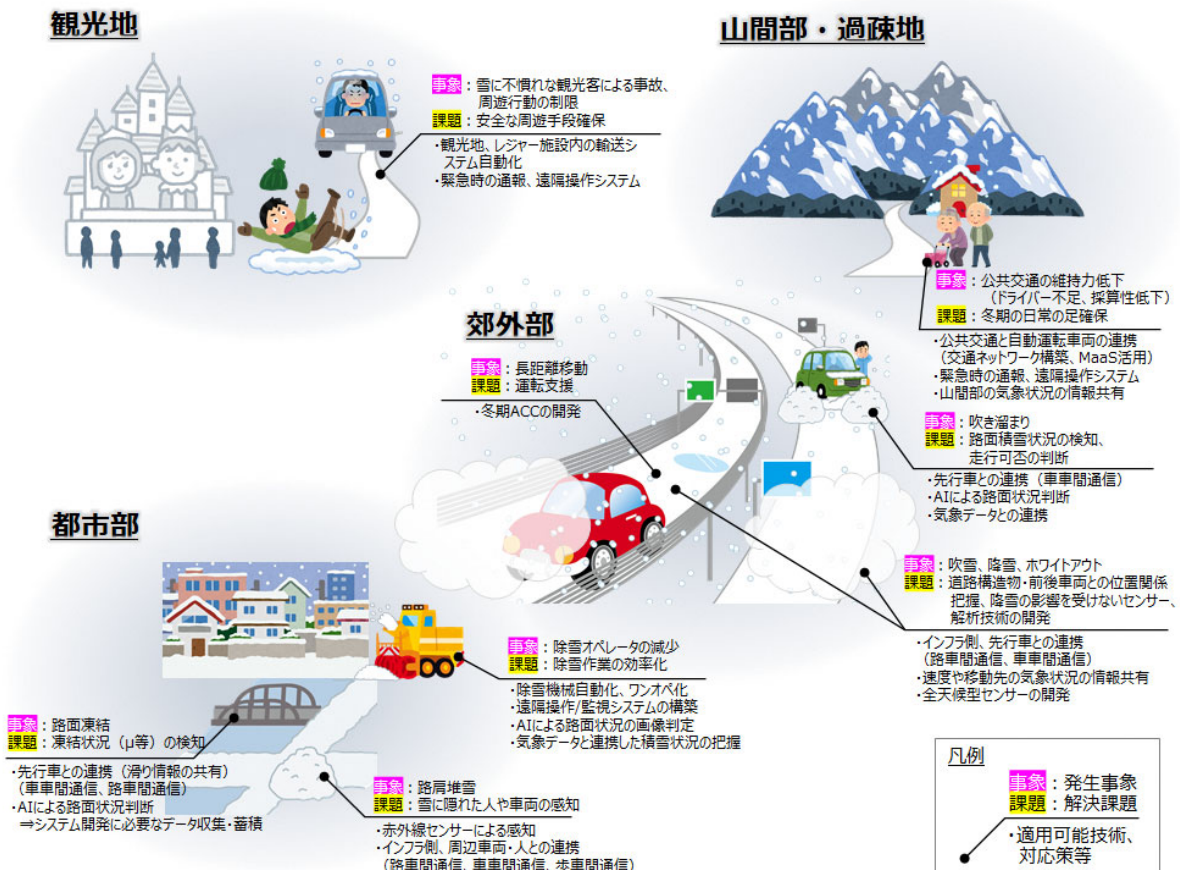
図 2-1 積雪寒冷地におけるユースケースに応じた自動運転の課題と対応策(案)
