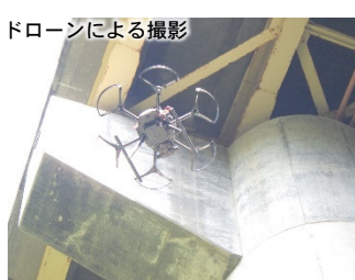
撮影写真からコンクリートのひび割れを自動検出し、幅・長さをデータ化
