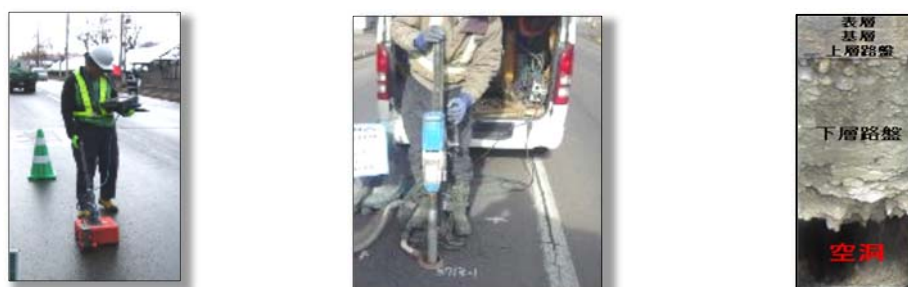
写真 2-2 二次調査 ハンディ型の地中レーダ・スコープ調査と空洞の例
