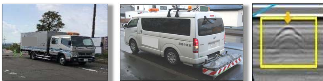
写真 2-1 一次調査の探査車と異常信号の例
