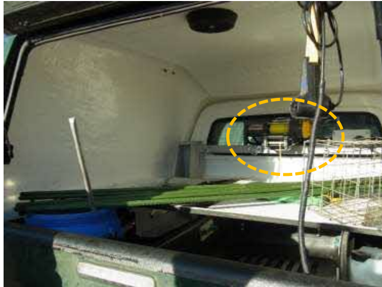
図 22 イギリス国有林で使われているシカ捕獲用の車。カバーのついた荷台に回収用のウインチ（点線内）が付いている。
