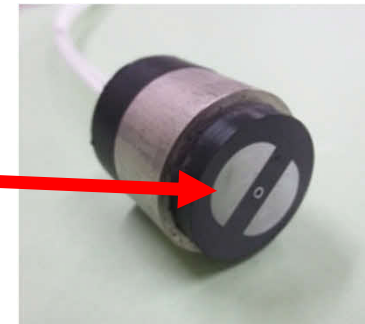
腐食センサーの写真
