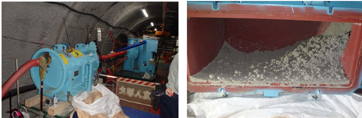
写真 5 吸引機の外観と、捕集した充填材
