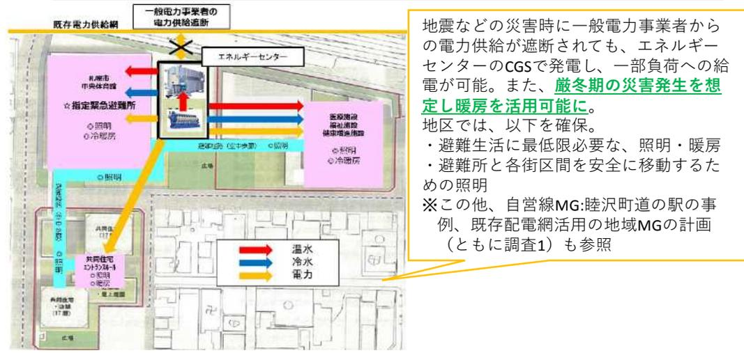
地震などの災害時に一般電力事業者からの電力供給が遮断されても、エネルギーセンターのCGSで発電し、一部負荷への給電が可能。また、**厳冬の災害発生を想定し暖房を活用可能に**。
