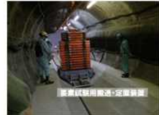
要素試験の実施状況 (エアベアリング方式)
