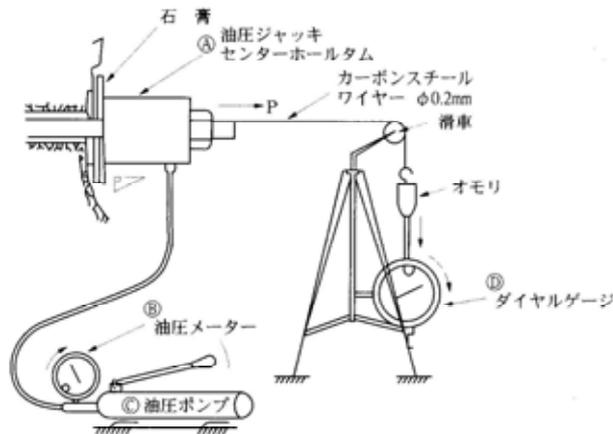
図－３ 引抜試験概要図
