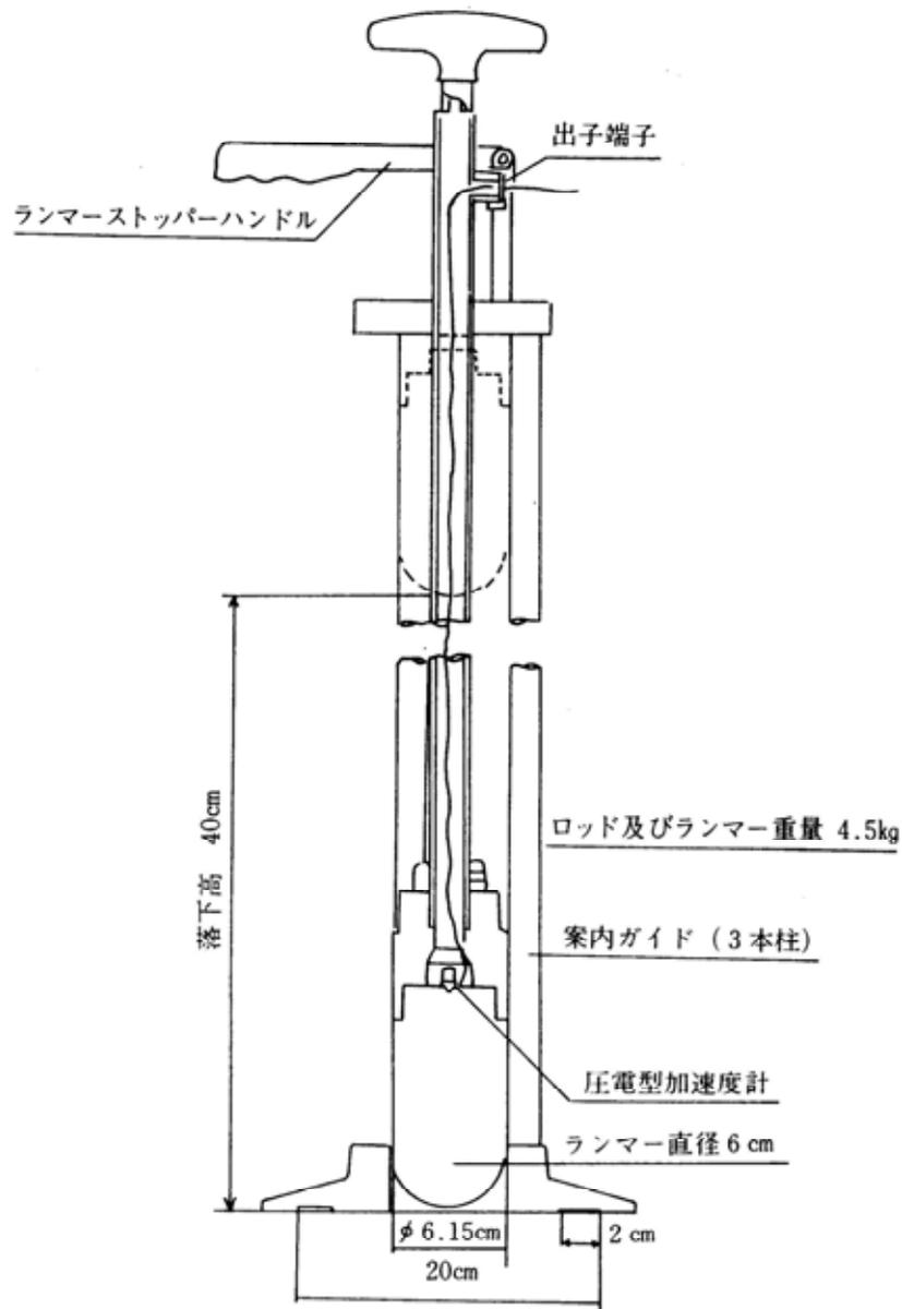
図-1 衝撃加速度試験器
