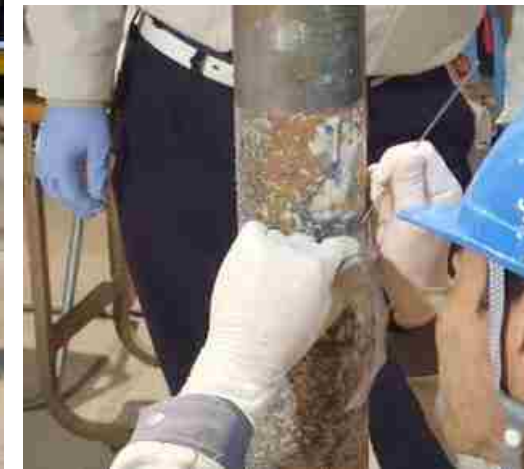
模擬オーバーパックの取り出し・腐食生成物の採取
