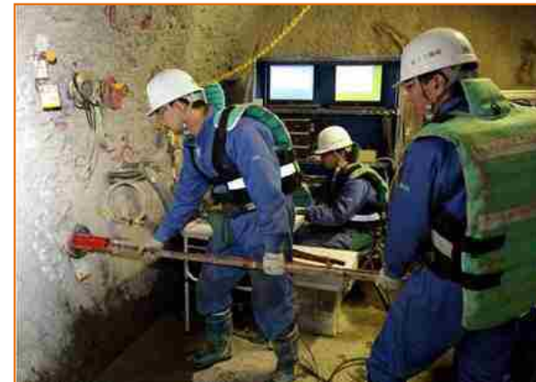
掘削影響試験（岩盤の変形特性の計測）
