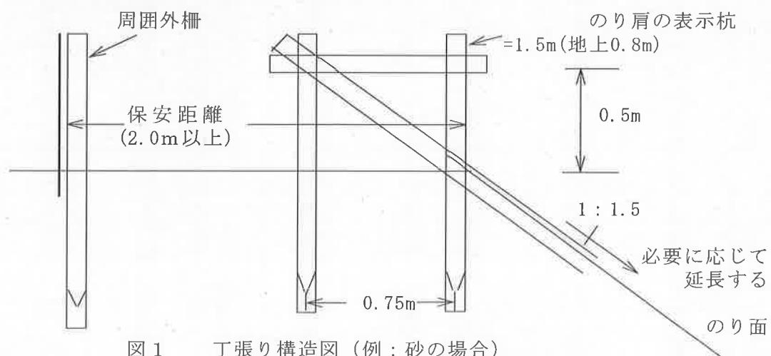
図1 丁張り構造図 (例: 砂の場合)
