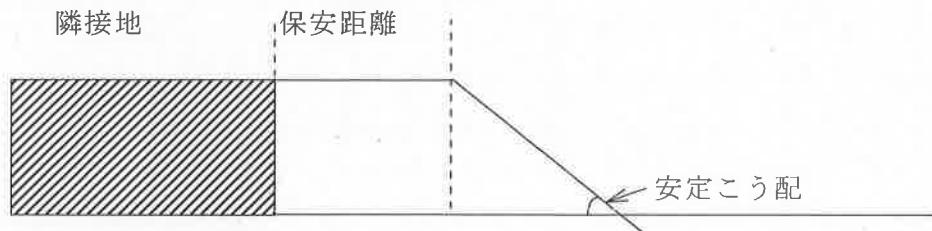
(矢板等による崩落防止措置を講じ、安定こう配より急な角度で掘削する)
