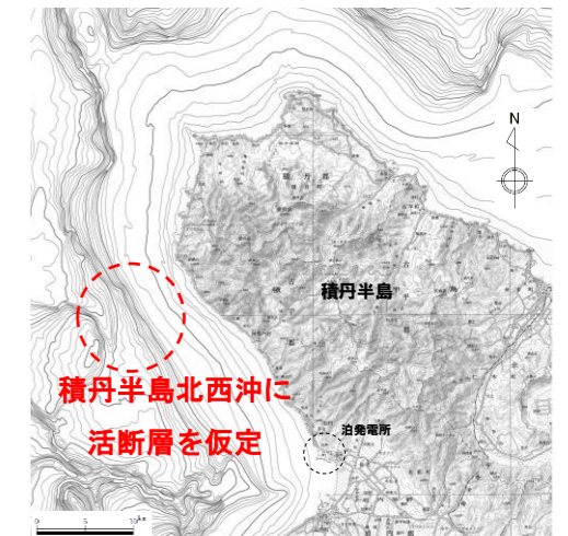
活断層の仮定位置
