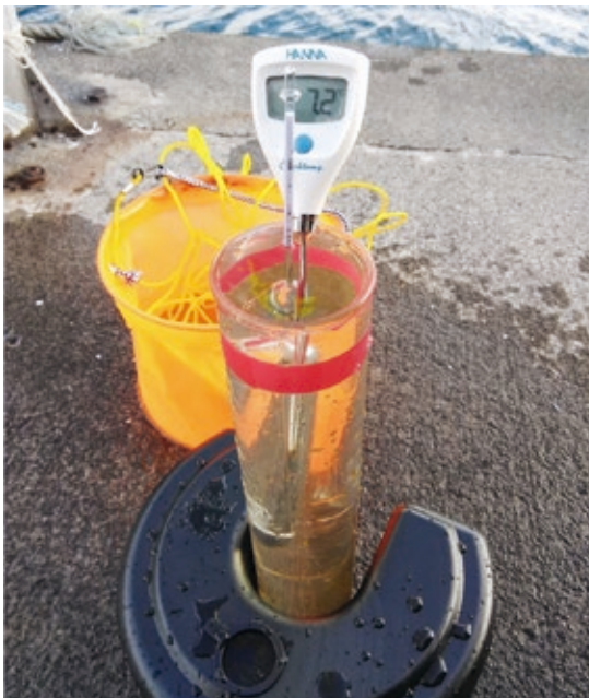
図1.バケツで汲んだ海水の水温と比重の測定
