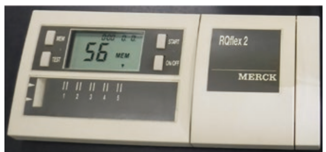
④ 発色した試験紙をRQフレックス（↑）の測定部に挟んで測定する。表示値を100倍した値が葉柄硫酸濃度。
