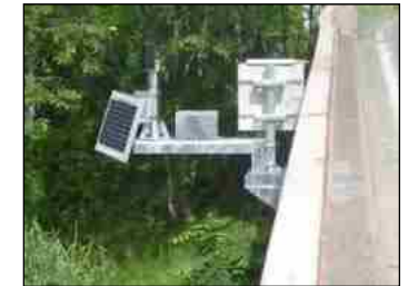
危機管理型水位計 (洪水時に特化した低コスト水位計)
