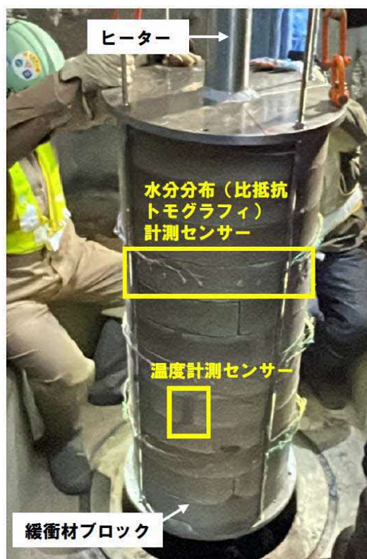
図 25 試験体設置の様子
