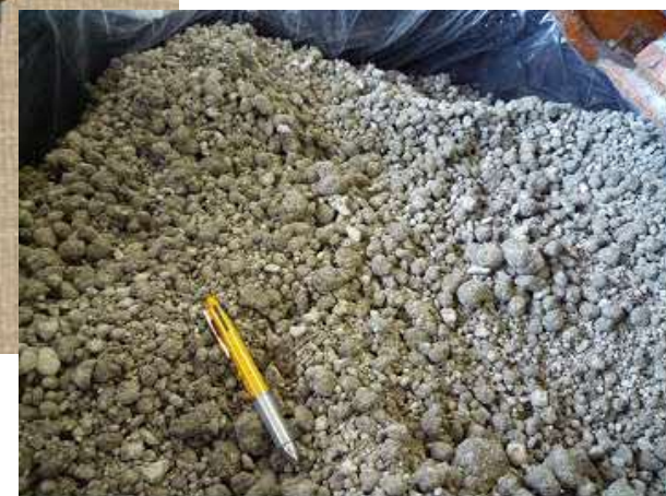
掘削土（ズリ）を用いた埋め戻し材
